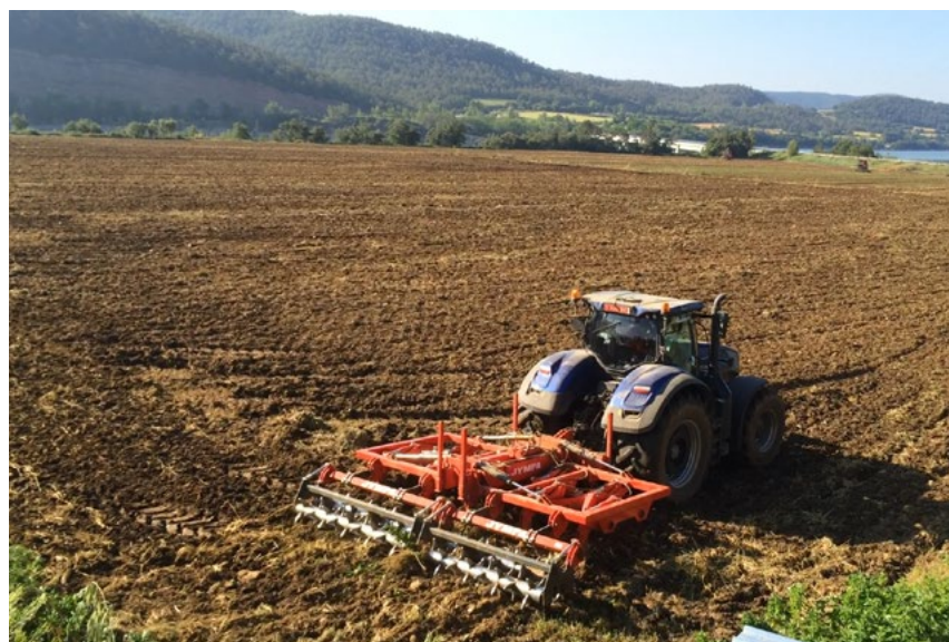
Modelo POLARIS-7 con rodillo doble Ø 520 mm con regulación mecánica
